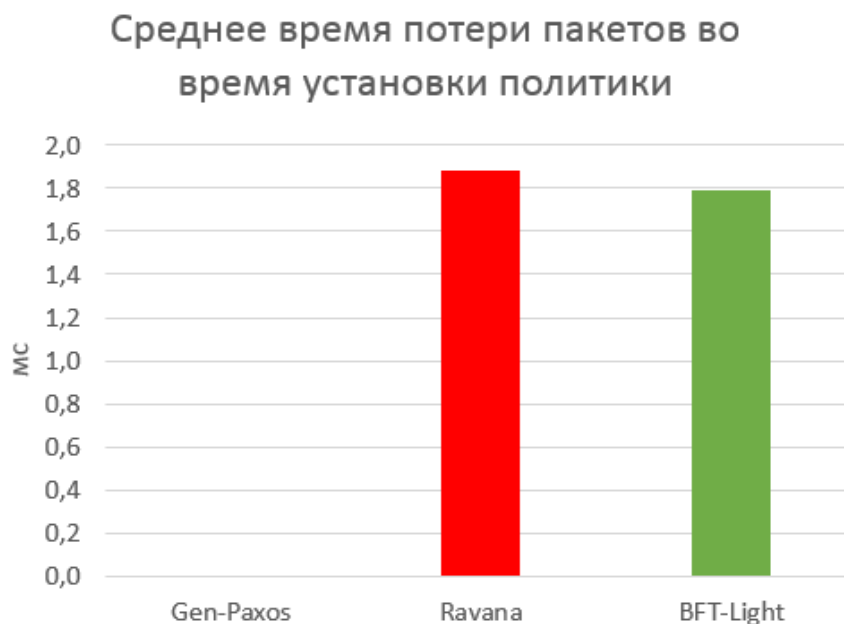
Рисунок 5 – Сравнение времени, в течение которого теряются пакеты, при установке сетевой политики с использованием различных протоколов контрольного слоя.
